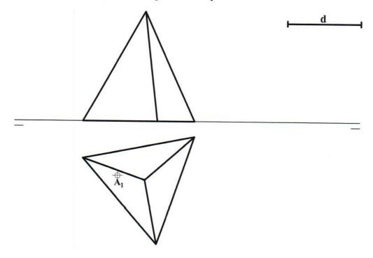
A3.- Representar en perspectiva caballera,  $C_y = 1/2$ , la pieza dada por sus vistas diédricas normalizadas. Indicar únicamente la parte visible de la pieza.
